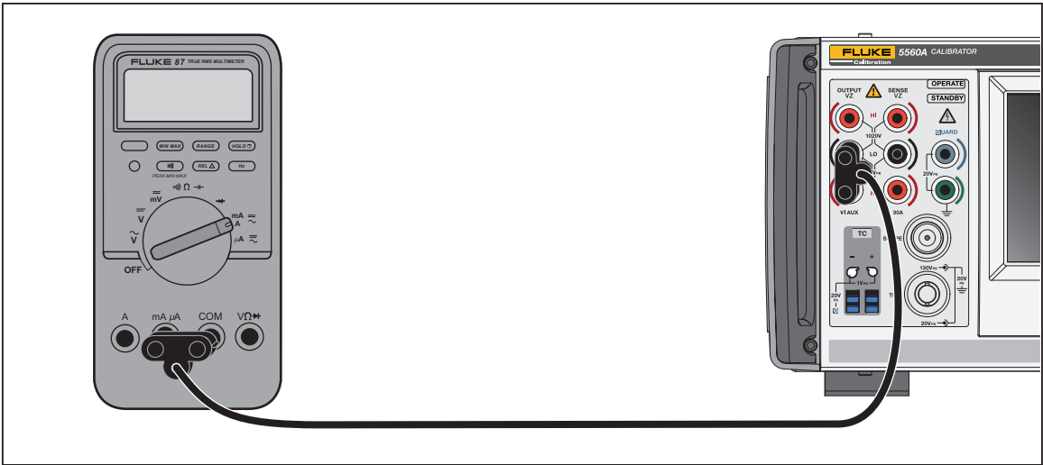
Abbildung 7. Prüfling-Verbindung: Gleich-/Wechselstrom < 3,1 A
