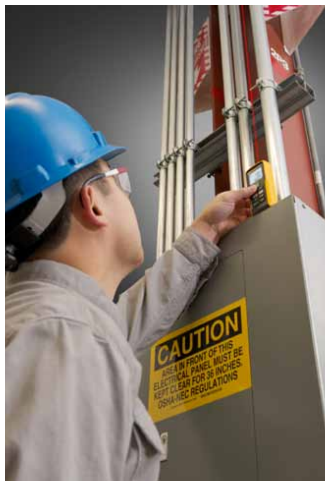
Messen der Höhe hoher Decken
