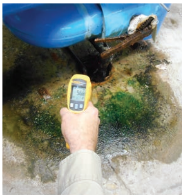
Temperatur von Kondensat messen, während es abfließt
