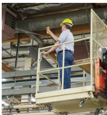
Temperatur von Ausrüstungen an Decken messen
