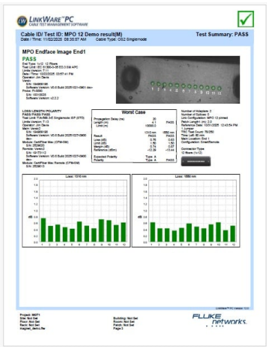
Der LinkWare PC-Bericht zeigt für ein 12-Faser-MPO-Kabel die Endflächen-Bild- und Dämpfungsergebnisse (einschließlich PASS für jedes einzelne).
