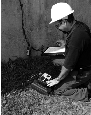
Verwendung der ART -Methode mit einem Megger DET3-Gerät zur Prüfung kommerzieller Erdungen ohne Trennen des Systems
