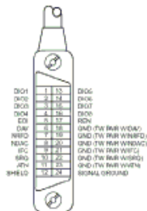
Abbildung 6: Steckerbelegung IEEE488
