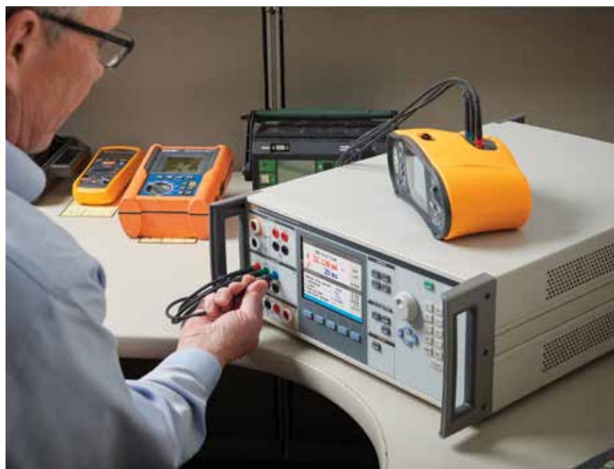
Jeder 5322A wird mit einem externen R-Multiplikator zum Ausgeben von Widerständen von 10 TΩ für das Prüfen von Isolationsmessgeräten geliefert.
