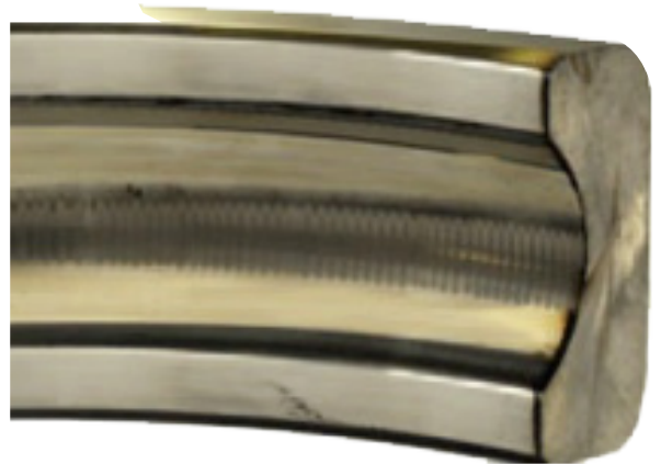
Riefen an einem Laufring werden durch Lagerströme verursacht (Foto mit freundlicher Genehmigung von Electro Static Technology).
