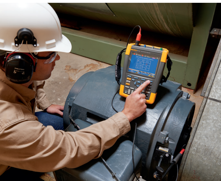
Messen der Motorwellenspannung mit dem Wellenspannungssonden-Kit
