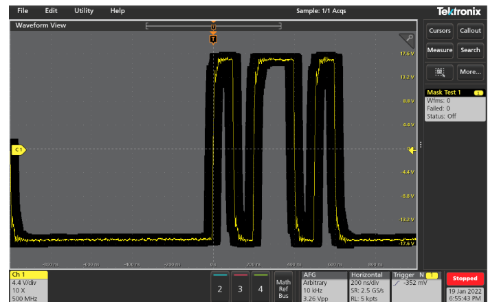
Grenzmaskentest basierend auf einem digitalen Referenzsignal
