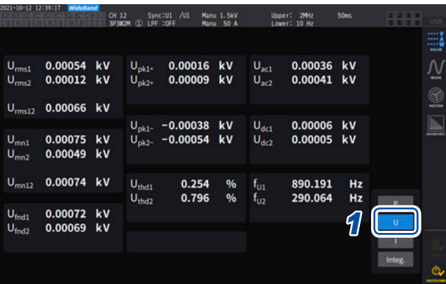
Beispiel: Anzeigen von gemessenen Spannungswerten
