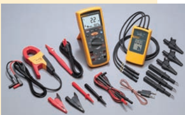
Fluke 1587 MDT Advanced: Professionelles Kit zur Fehlersuche an Motoren und Antrieben
