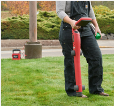
Verfolgen einer einzelnen Versorgungsleitung durch direkten Anschluss der Messleitungen an den Sender
