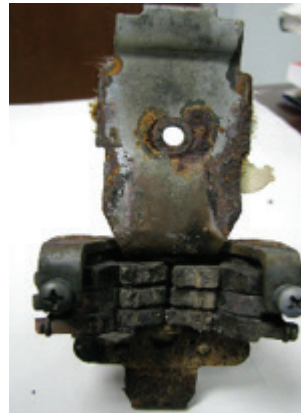
Abb. 28: Korrosion an Leistungsschalter
