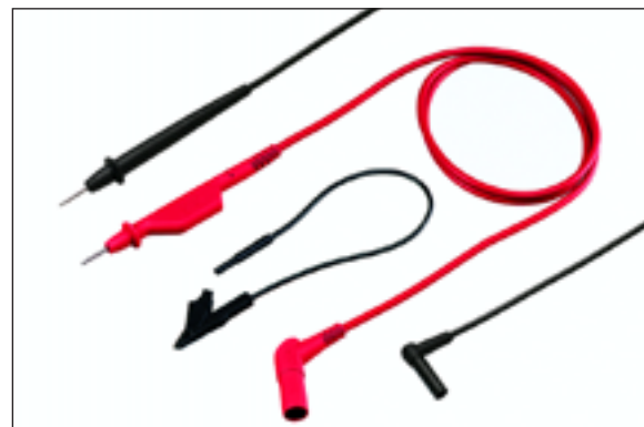
Bild 2: Die Messleitungen STL120 (rot) und TL75 (schwarz) sind die wesentlichen Werkzeuge für Messanschlüsse an einem FOUNDATION Fieldbus. Bei starkem Rauschen am Bus die kürzere Leitung mit der Krokodilklemme (mittlere Leitung) verwenden. Alle drei Messleitungen sind beim Fluke 125 ScopeMeter im Lieferumfang enthalten.
