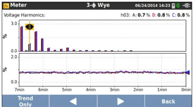
Das Balkendiagramm mit den Oberschwingungen und der Trend sollten bei der Dokumentation berücksichtigt werden.
