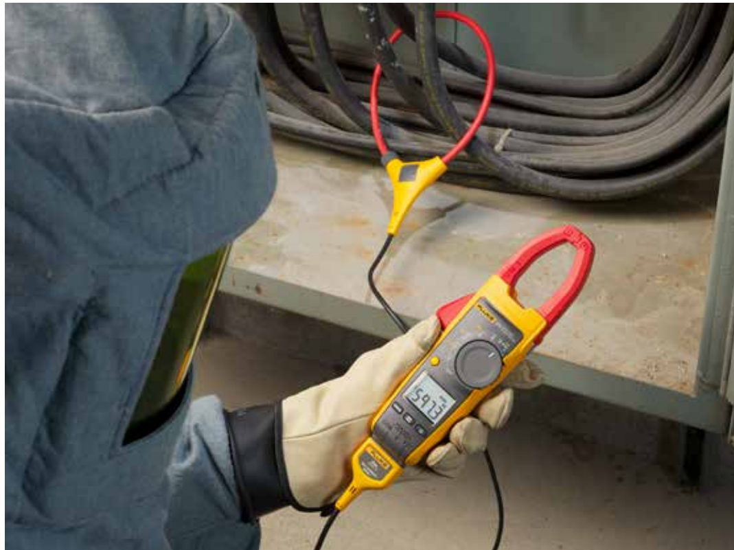
Beachten Sie bei der Wahl einer Strommesszange die elektrischen Werte Ihrer Arbeitsumgebung sowie die Auflösung und Genauigkeit, die Sie für Ihre Messungen benötigen.
