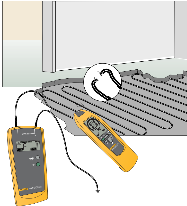
Fehlersuche in einer elektrischen Fußbodenheizung
