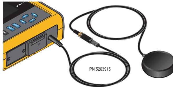
3. Schließen Sie die GPS-Antenne an das Antennenkabel an.
