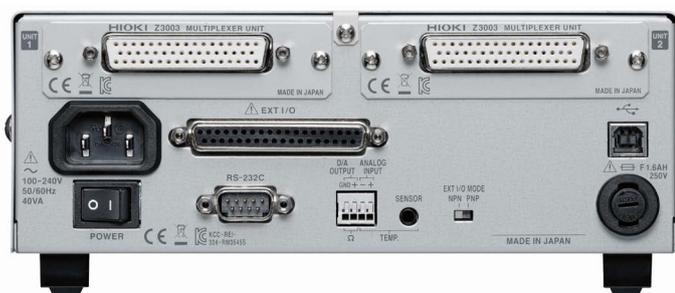
Abbildung 2: Rückseite des RM3545-02 (mit zwei Multiplexer-Karten Z3003)
