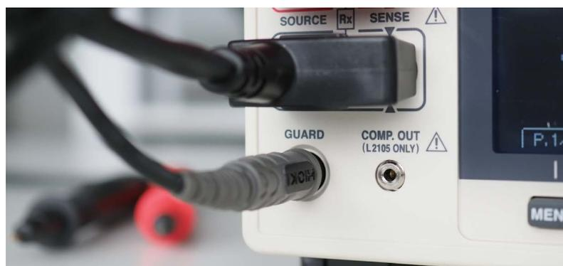
Abbildung 4: Guard-Anschluss: Stabilere Messungen in hohen Widerstandsbereichen
