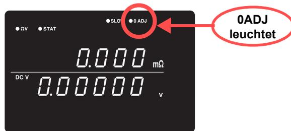
Nach der Messung wird der Messwert der von der Nullabgleichsfunktion angewendeten Kompensation angezeigt.
