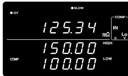
Anzeige von Spannungsmessung und Komparator (Zeigt den gemessenen Spannungswert und den Einstellungswert des Spannungskomparators an)
