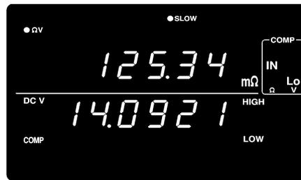
Anzeige von Widerstandsmessung und Komparator (Zeigt den gemessenen Widerstandswert und den Einstellungswert des Widerstandskomparators an)
