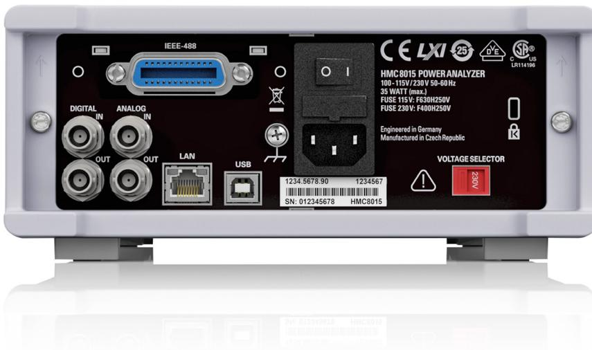
Rückseitige Schnittstellen (abgebildet ist ein R&S®HMC8015-G mit GPIB-Schnittstelle)
