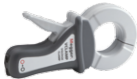
1001-013 (VCLAMP) Stromzange (Öffnung 54 mm) zur Induktion einer Spannung in eine geschlossene Leiterschleife. Anwendung zur spießlosen Erdungsmessung als induzierende Stromzange
