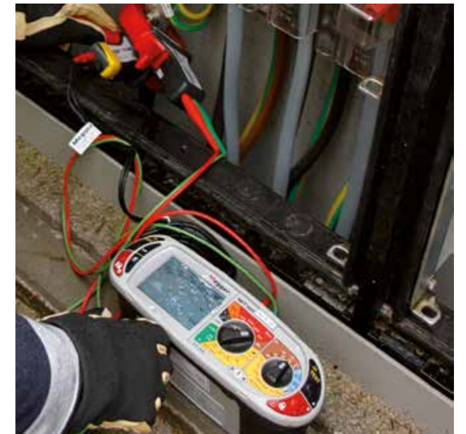
MFT1845 ist bei jedem Wetter sogar mit Schutzhandschuhen bedienbar
