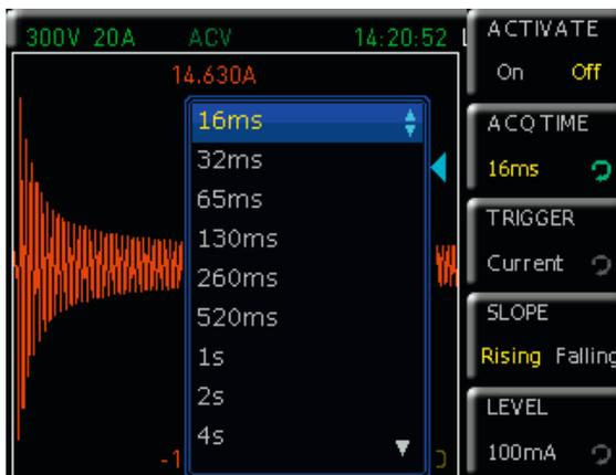
Inrush-Ansicht für eine anlaufende Bohrmaschine
