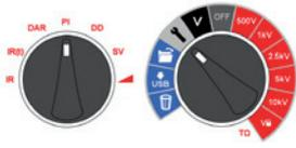
DAR- und PI-Prüfungen messen den Widerstand im Zeitverlauf, ausgedrückt als Verhältnis des Widerstands zur Zeit t2 dividiert durch den Widerstand zur Zeit t1. Es wird davon ausgegangen, dass die Isolationstemperatur während der Prüfdauer nicht stark variieren wird, daher ist der DAR- und/oder PI-Wert unabhängig von der Temperatur. Damit diese Annahme zutreffend ist, müssen die Prüfungen bei Temperaturen von max. 40°C (104° F) durchgeführt werden.
