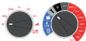
Für die Einstellung der benutzerdefinierten Lock-Spannung VL drehen Sie den mittigen Drehschalter auf die Einstellungen und den Modus-Schalter auf IR. Die voreingestellte Spannung, 5.000 V, blinkt und kann mit den Tasten Vor/Zurück verändert werden. Wenn die Höchstspannung angezeigt wird, drücken Sie die Taste OK, um den Wert zu speichern. Diese Einstellung bleibt erhalten, bis der Wert zurückgesetzt wird.
