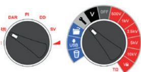
Zu Beginn der zeitgesteuerten Prüfung IR(t) wird die Isolationsprüfung automatisch nach einer voreingestellten Periode beendet. Standardmäßig ist der Timer auf 1 Minute eingestellt; dieser Wert kann mit der Einstellungsfunktion geändert werden.
