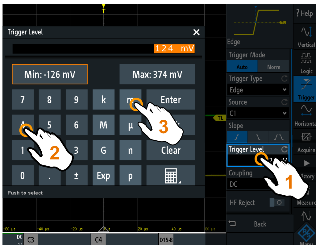
Bild 4-5: Numerischen Wert und die Einheit eingeben
