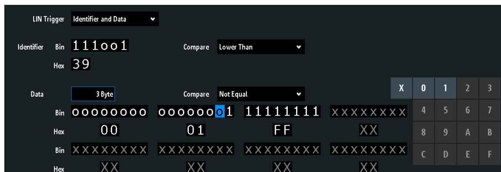
Bild 13-32: Triggereinstellungen für Triggerung auf Adress- und Datenmuster
