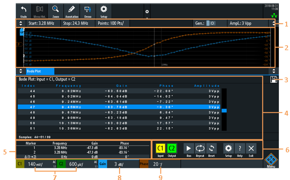
Bild 9-8: Anzeige des Bode-Diagramms
