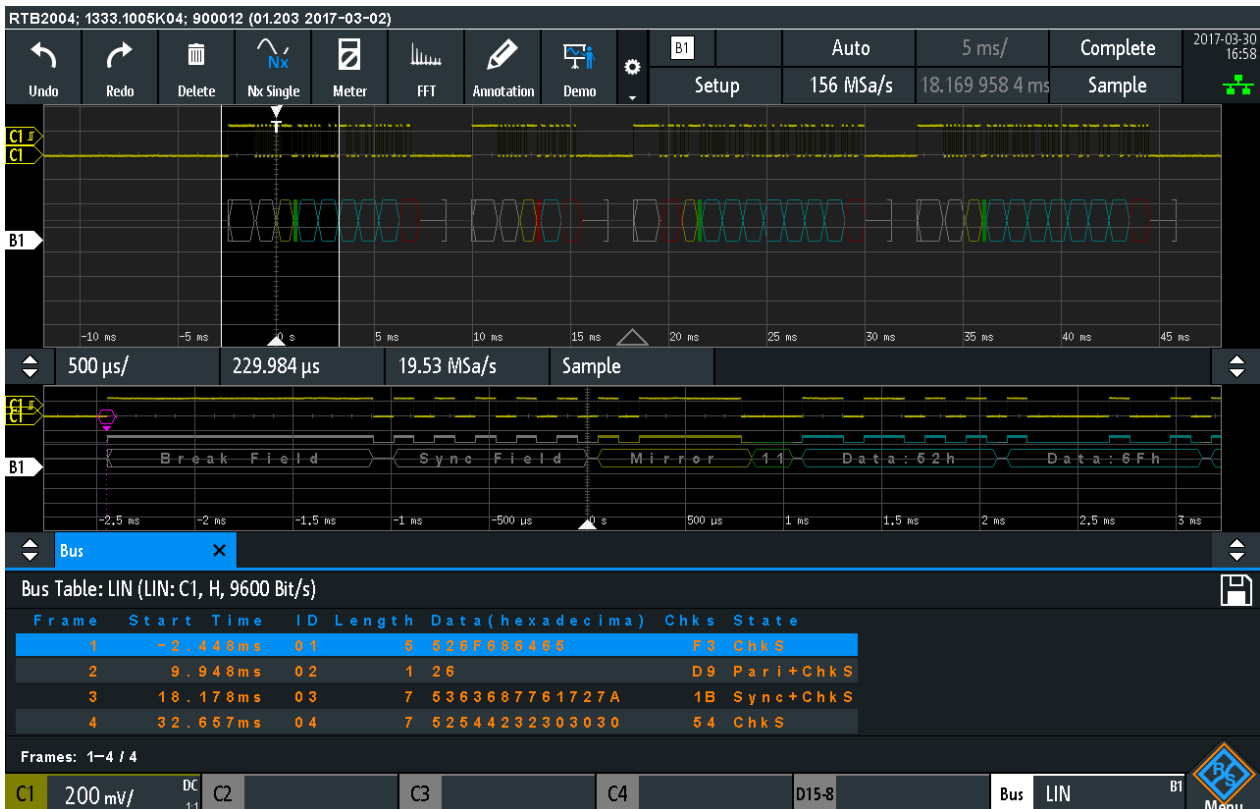
Bild 13-37: Decodiertes LIN-Signal mit Frametabelle und angewendeter Label-Liste
