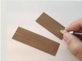
Messung zweier Leitungen zur Bestimmung der frequenzabhängigen Dielektrizitätskonstante
