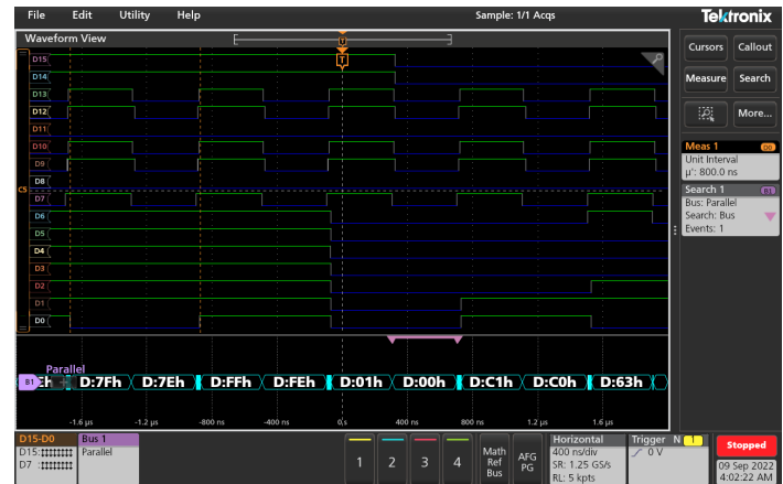
Triggerung und Dekodieren von digitalen Kanälen
