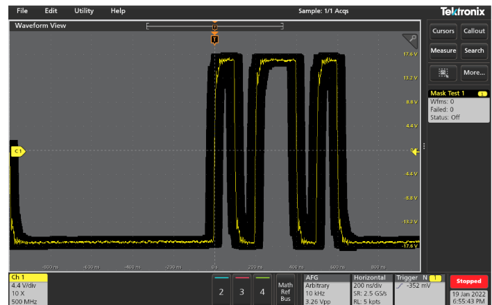
Grenzmaskentest basierend auf einem digitalen Referenzsignal
